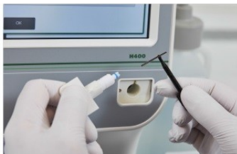
2. Vložení kapiláry do MPA adaptéru
