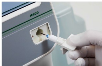
3. Zasunutí adaptéru MPA do analyzátoru
