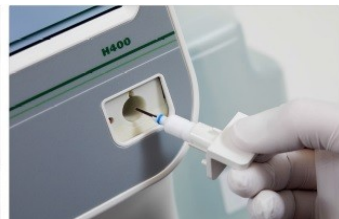
3. Zasunutí adaptéru MPA do analyzátoru, výsledek je k dispozici do 1 minuty
