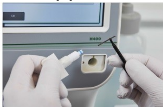
2. Vložení kapiláry do MPA adaptéru
